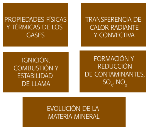
Figura 2.21. Aspectos diferenciales entre la combustión convencional y la oxi-combustión
