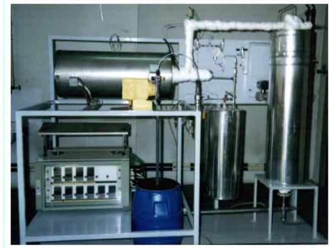
Planta piloto de limpieza de gases calientes
