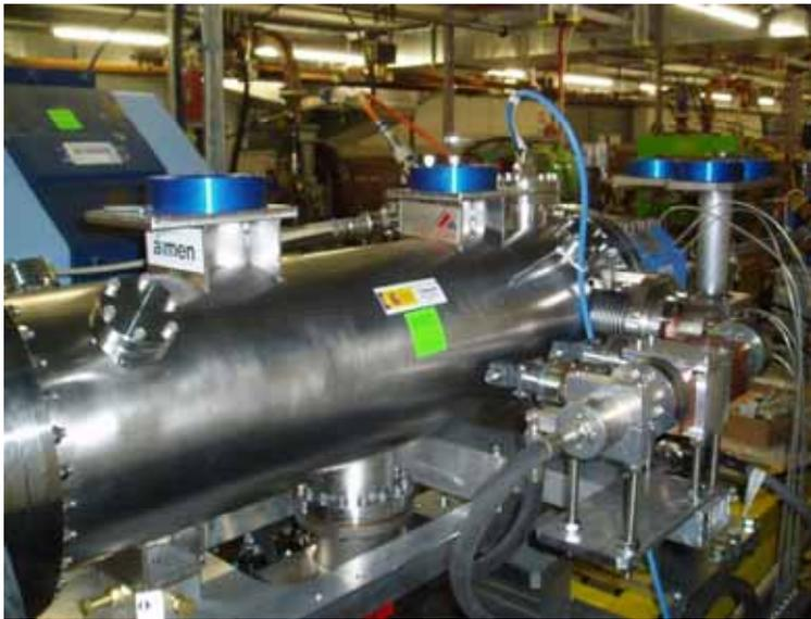
Tanque de vacío con estructura de radiofrecuencia PETS en su interior
